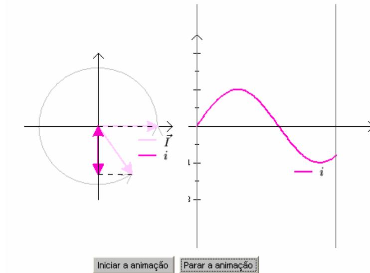
A amplitude complexa  $\vec{U}_R$  representando a tensão aos terminais da resistência é colinear com  $\vec{I}$ , isto é, tensão e corrente aos terminais da resistência, estão em fase.
