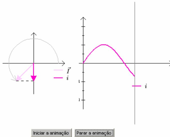
A amplitude complexa  $\vec{U}_R$  representando a tensão aos terminais da resistência é colinear com  $\vec{I}$ , isto é, tensão e corrente aos terminais da resistência, estão em fase.
