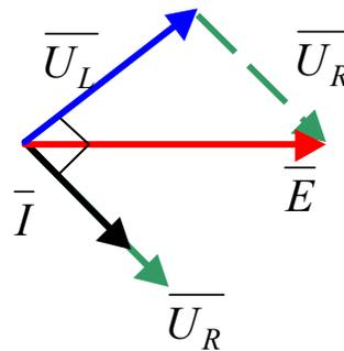
Figura 3 – Diagrama vectorial do circuito RL série
