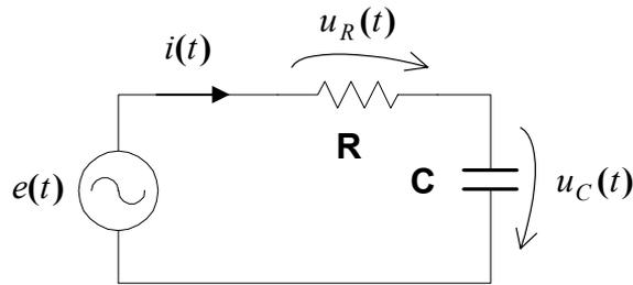
Figura 4 – Esquema do circuito RC série
