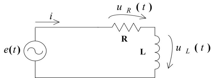
Figura 1– Esquema do circuito RL série
