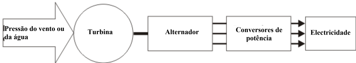
Figura 2. Cadeia eólica ou hidráulica de produção de electricidade
