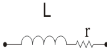
Figura 13 – Esquema equivalente de uma bobine real
